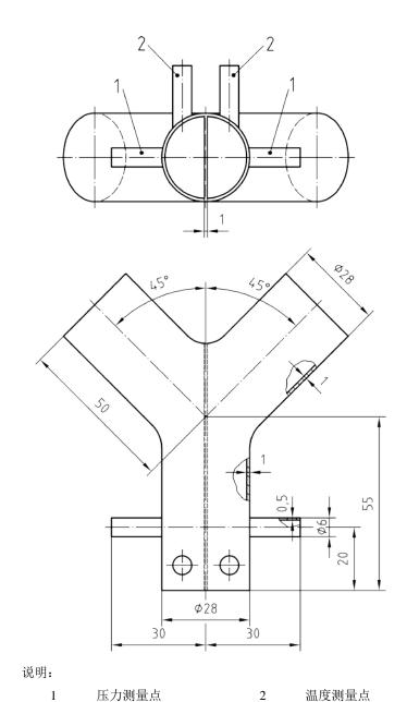
图4 口具组件式呼吸器试验用联接器
