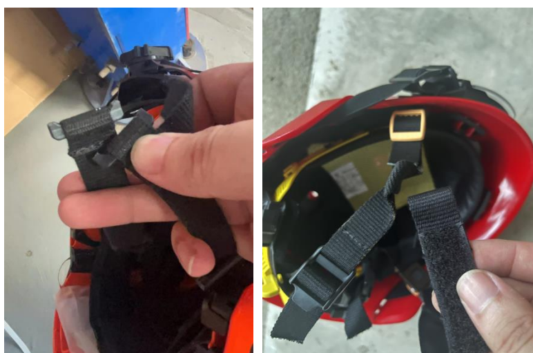
图 4 佩戴系统动态强度测试中出现的头盔受损情况
