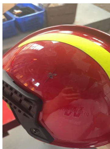
图2 经侧向穿刺后盔体发生碎裂
