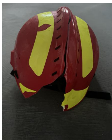
图1 经侧向冲击后盔体发生碎裂
