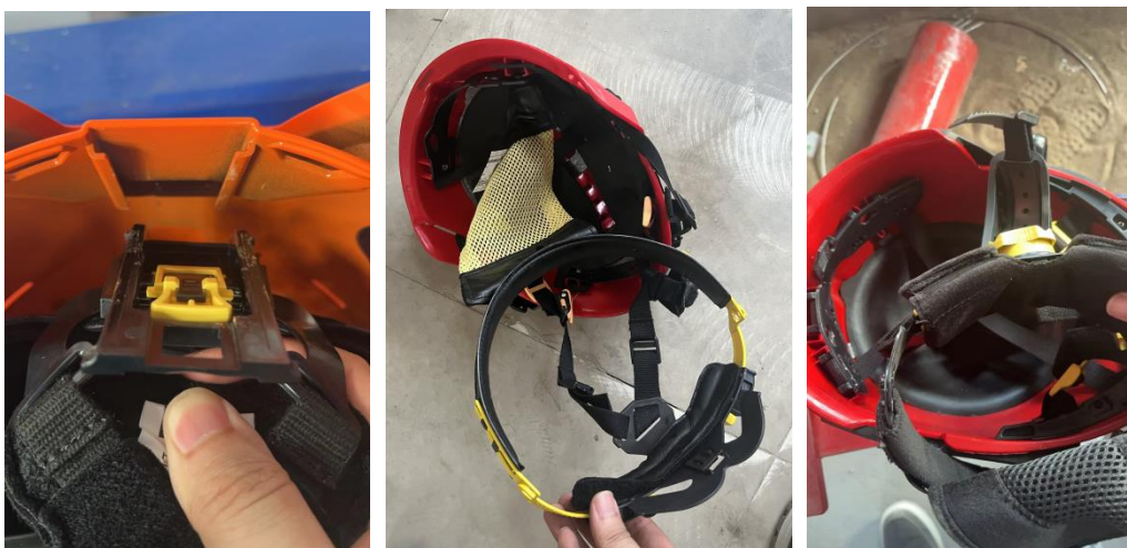
图 3 佩戴稳定性测试中出现的头盔受损情况
