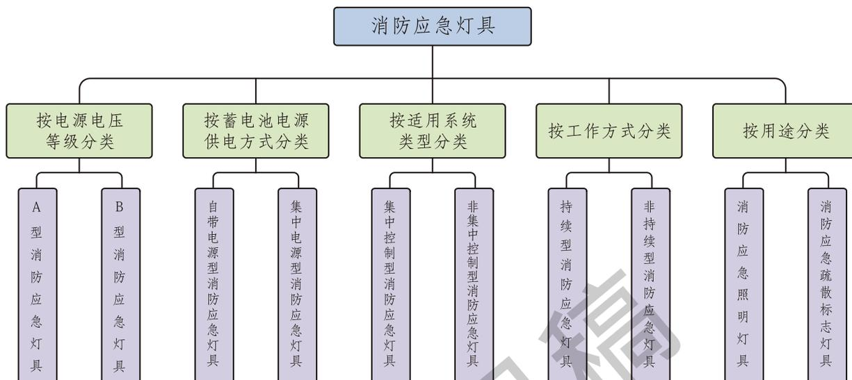
图 A.5 消防应急灯具分类示意图
