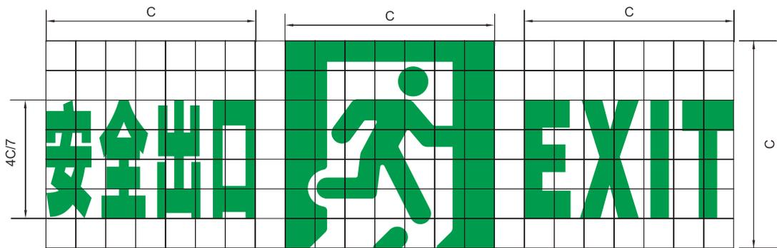
图 D. 8 安全出口标志图形
