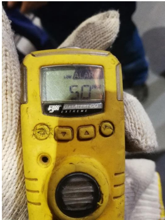
图 2-3 便携式一氧化碳检测仪检测现场一氧化碳浓度超标
