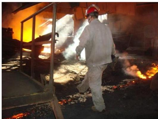
图 2-7 作业人员直接跨越渣、铁沟
