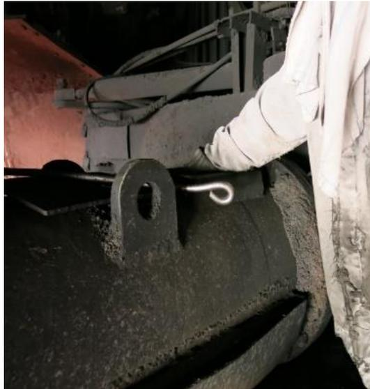
图 2-5 作业人员将手放入装泥口
